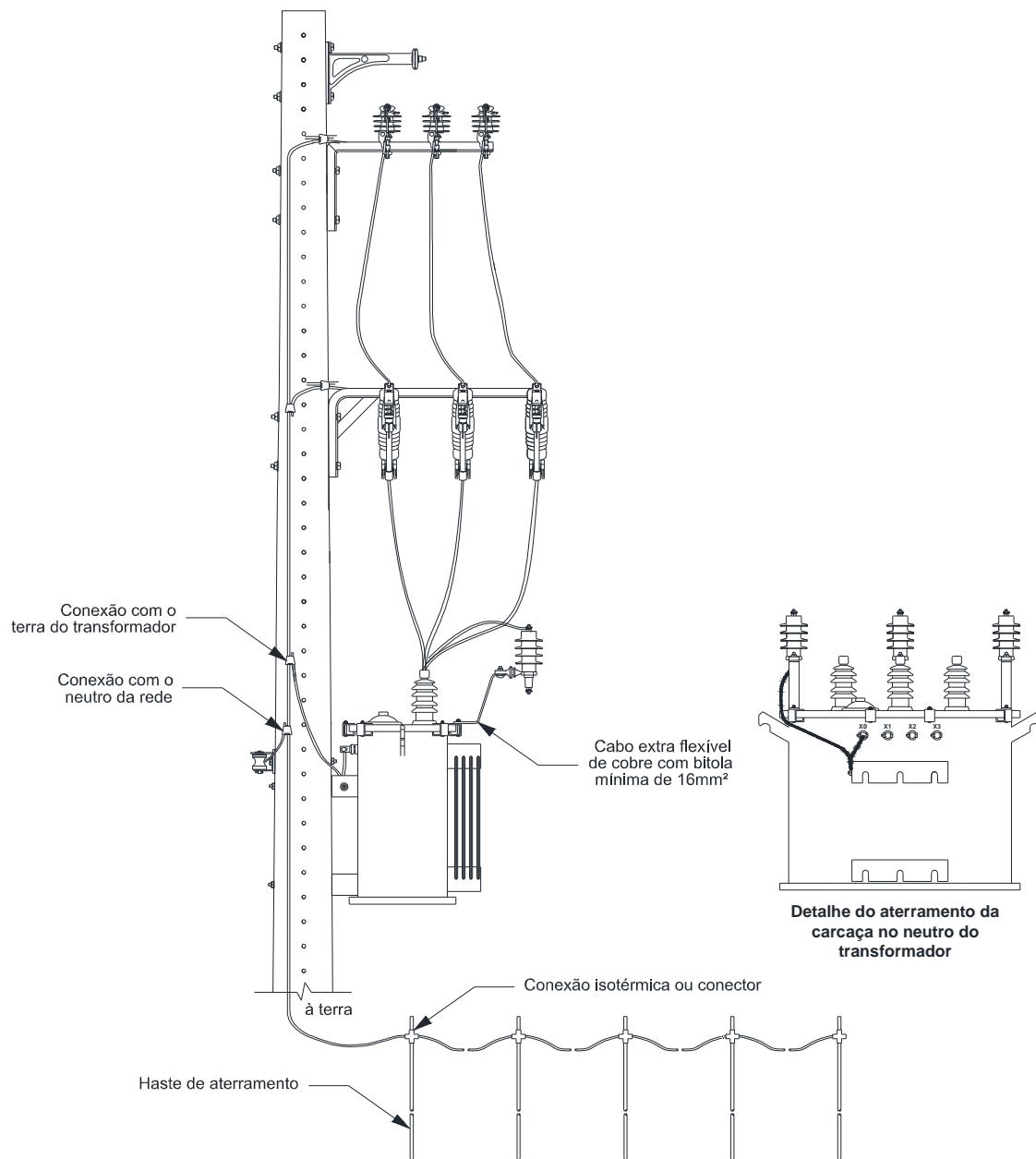
Figura 65 – Aterramento de equipamento – Alternativa
