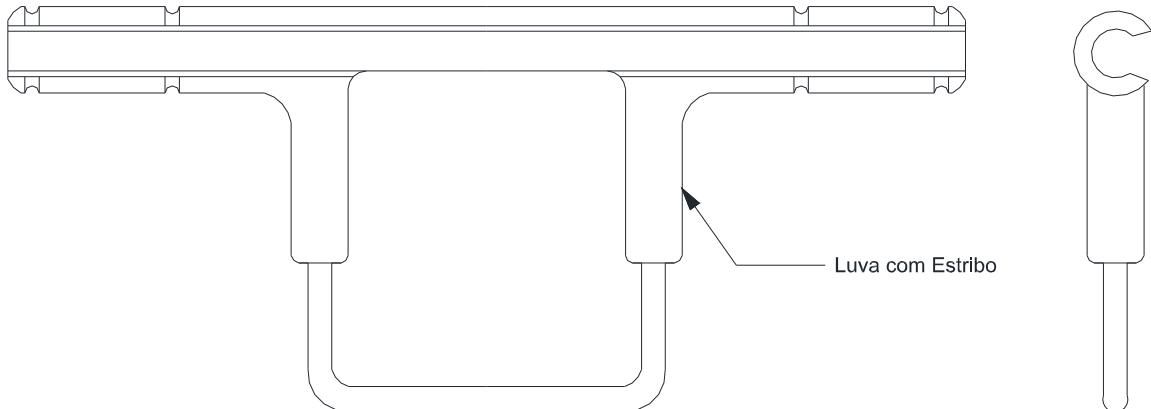
Figura 93 – Conexões e emendas – Conector luva estribo
