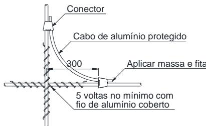
Detalhe da conexão do cabo mensageiro
