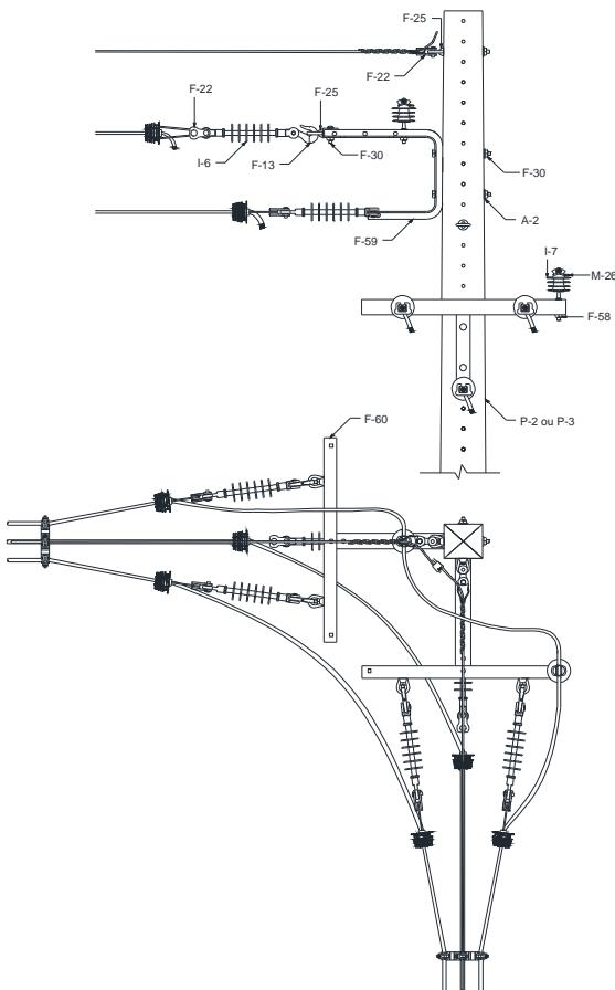
Figura 43 – Estrutura especial – Estrutura C3-C3
