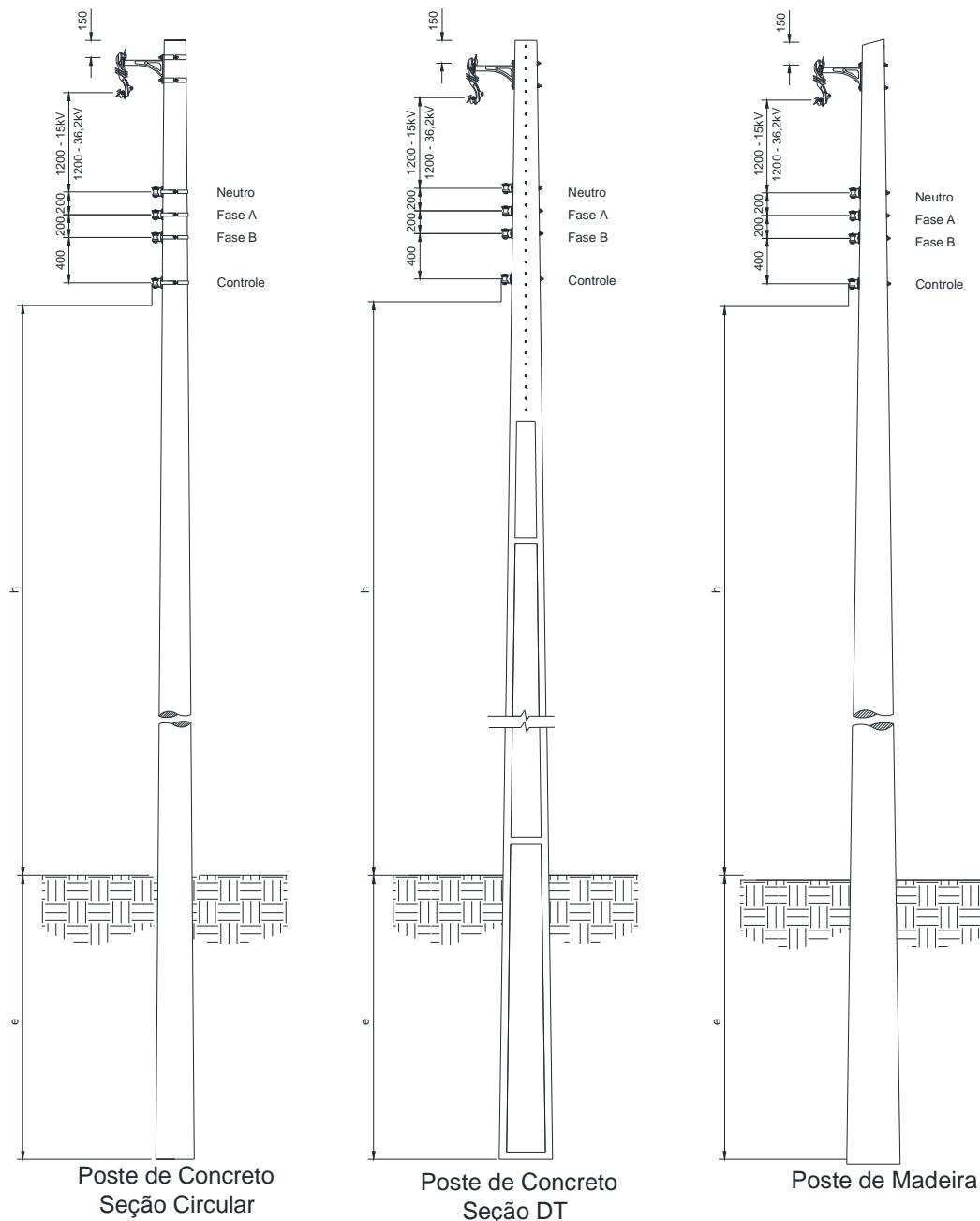
Figura 6 – Afastamentos mínimos – Estrutura monofásica tangente
