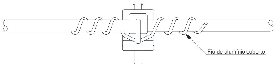
Figura 82 – Amarrações e ligações – Amarração do cabo protegido em espaçador monofásico, vertical e losangular – Fio de alumínio coberto
