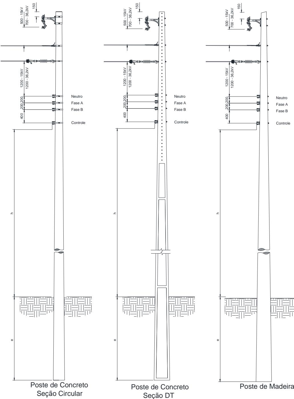
Figura 7 – Afastamentos mínimos – Estrutura monofásica tangente com derivação
