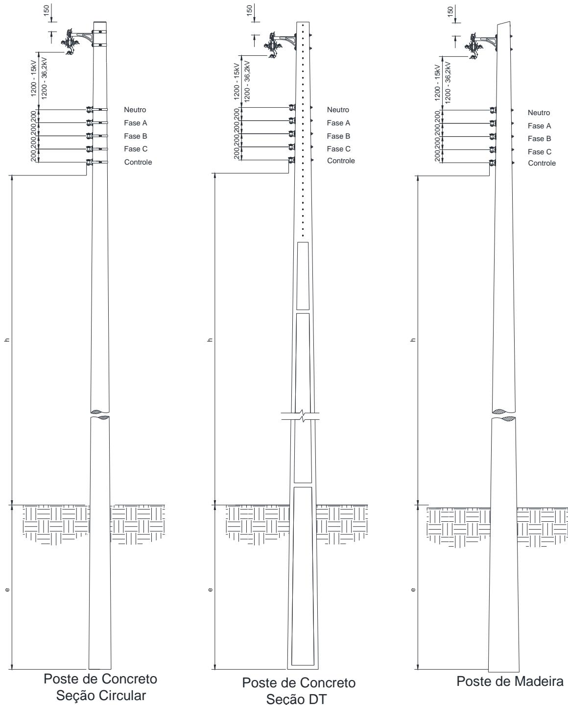
Figura 8 – Afastamentos mínimos – Estruturas trifásicas tangentes
