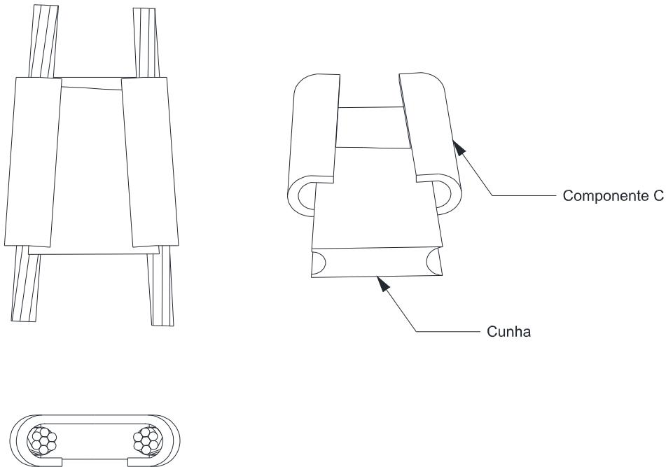
Figura 88 – Conexões e emendas – Conector cunha com estribo
